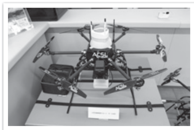
【上空気象観測用ドローン】
